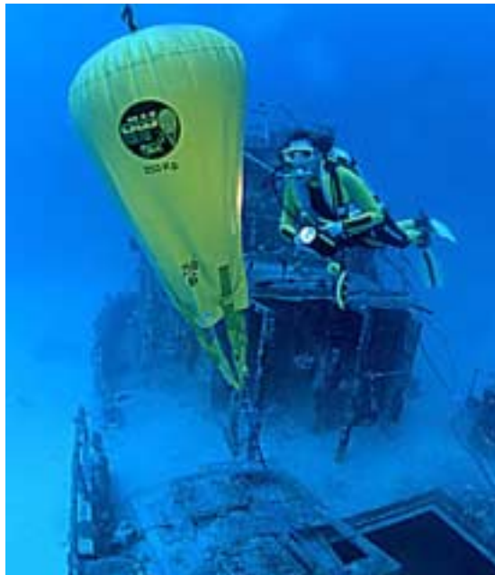
Lyftsäckar för bärgning under vatten, kapaciteter upp till 50 ton som standard.
