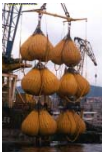
Säckar för provbelastning av kranar m.m..
