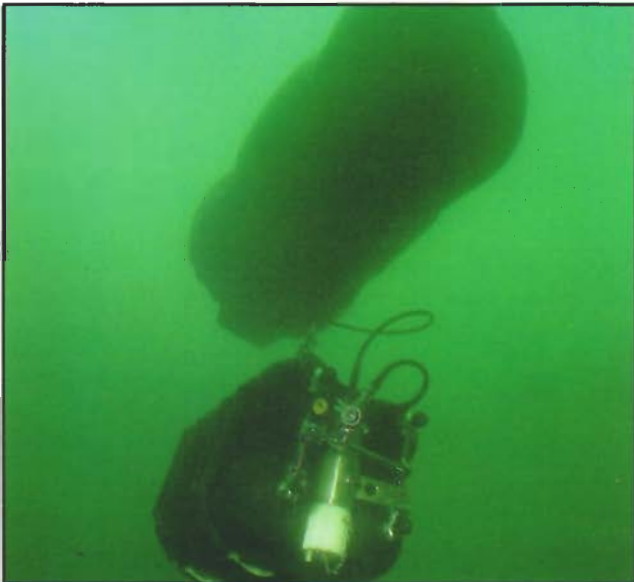
Vid lyft av minor används öppna och slutna lyftsäckar med tidsautomatik och lufförråd. Utrustningen har NATO-godkännande.
